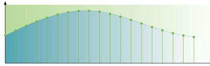
Семплирането с 192 kHz позволява точно възпроизвеждане на оригиналните звукови криви. В съчетание с 24-битовата разделителна способност от оригиналния аналогов звук се улавя повече информация, което води до много по-вярно аудио възпроизвеждане.
