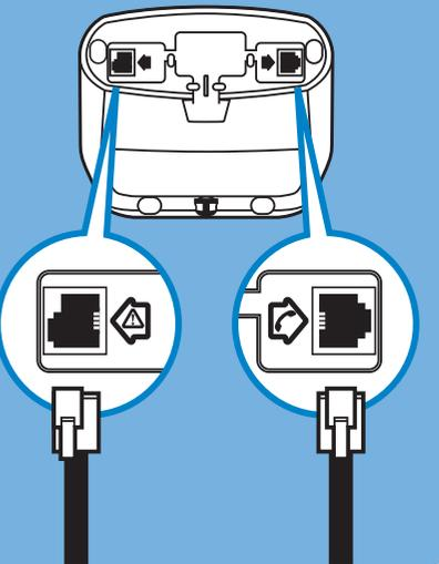
Drehen Sie die Basisstation um und stecken Sie das Telefonanschlusskabel und das Netzkabel in die jeweiligen Buchsen auf der Unterseite.
