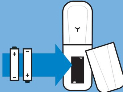
Legen Sie die Akkus ein und schließen Sie den Deckel des Batteriefachs
