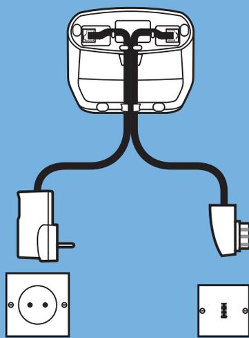
Stecken Sie das andere Ende des Telefonanschlusskabels in die Telefon-Wandsteckdose und das Netzteil in die Stromsteckdose ein.
