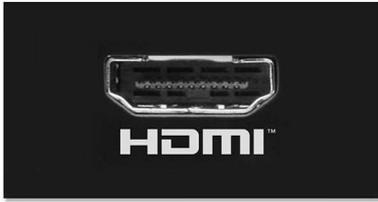
HDMI 是一个可以承载数字高清视频以及数字多声道音频的直接数字连接方式。由于无需转换为模拟信号，它可以产生优异的画面和声音效果，完全不受噪音干扰。HDMI 完全向后兼容 DVI。
