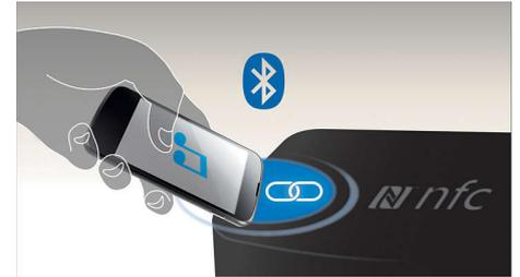
Empareja dispositivos Bluetooth fácilmente con la tecnología de un toque NFC (comunicaciones por proximidad). Solo tienes que tocar con el smartphone o la tableta con NFC la zona NFC del altavoz para encenderlo, iniciar el emparejamiento a través de Bluetooth y comenzar a transmitir música.
