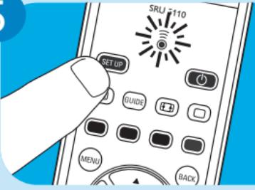
Håll knappen SET UP intryckt i 5 sekunder för att avsluta inställningsläget och spara inställningarna.
