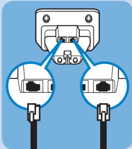
Inserire il connettore del cavo di alimentazione e quello del cavo telefonico nella parte posteriore della base.
