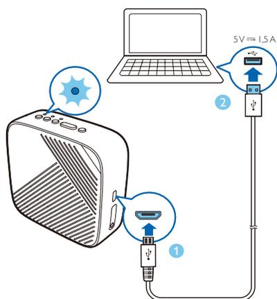
Povežite USB kabl između USB priključka na zvučniku i USB priključka na kompjuteru ili punjaču.
