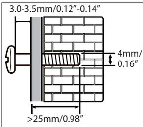
Consulte la ilustración en la guía de inicio rápido sobre cómo montar el SoundBar en la pared.
