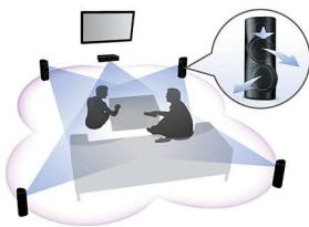
Gli altoparlanti 3D angolari sono dotati di driver angolati per produrre l'audio non solo anteriormente ma anche sui lati creando un'area di diffusione più ampia per un audio surround più coinvolgente come al cinema.
