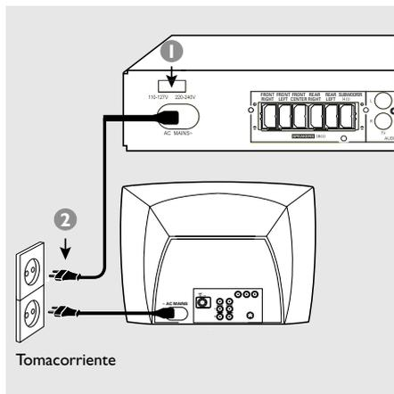
**Después de que todo esté conectado correctamente, enchufe el cable de alimentación de CA en el tomacorriente.**
