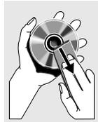
– Escriba solamente en el lado impreso de un CD-R/CD-RW y solamente utilizando un rotulador de punta blanda.
