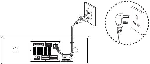
Povežite kabl za napajanje u utičnicu na zidu.
