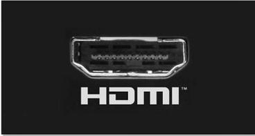
HDMI adalah koneksi digital langsung yang dapat membawa video HD digital serta audio multichannel digital. Dengan menghilangkan konversi ke sinyal analog, cara ini memberikan kualitas gambar dan suara yang sempurna, benar-benar bebas dari noise. HDMI sepenuhnya kompatibel dengan DVI.
