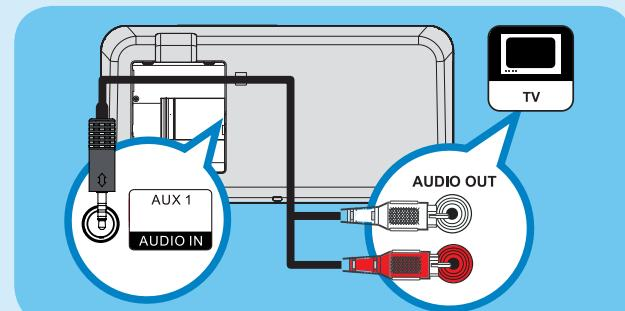
**Remarque** Pour diffuser le son provenant de la sortie audio de l'appareil connecté, appuyez plusieurs fois sur **AUX/DI/MP3 LINK** jusqu'à ce que « AUX1 INPUT » (Entrée AUX 1) apparaisse sur l'afficheur.
