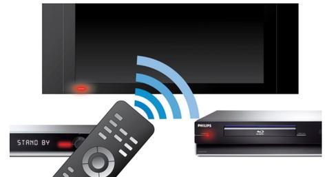
EasyLink consente di controllare più dispositivi come lettori DVD, Blu-ray, altoparlante SoundBar, Home Theater, TV e così via con un unico telecomando. Utilizza il protocollo standard del settore HDMI CEC per condividere funzionalità tra vari dispositivi attraverso il cavo HDMI. Con un solo comando, puoi far funzionare contemporaneamente tutte le apparecchiature compatibili con HDMI CEC. Funzioni come lo standby e la riproduzione possono essere controllate in tutta semplicità.
