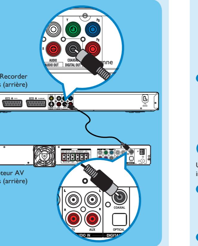
Ce raccordement permet au récepteur AV de relayer le son de l'enregistreur. La sortie de son Surround multicanal est prise en charge.
