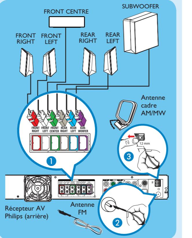
1 Insérez les différentes fiches des enceintes et du caisson de basses aux prises de même couleur sur le récepteur AV.
