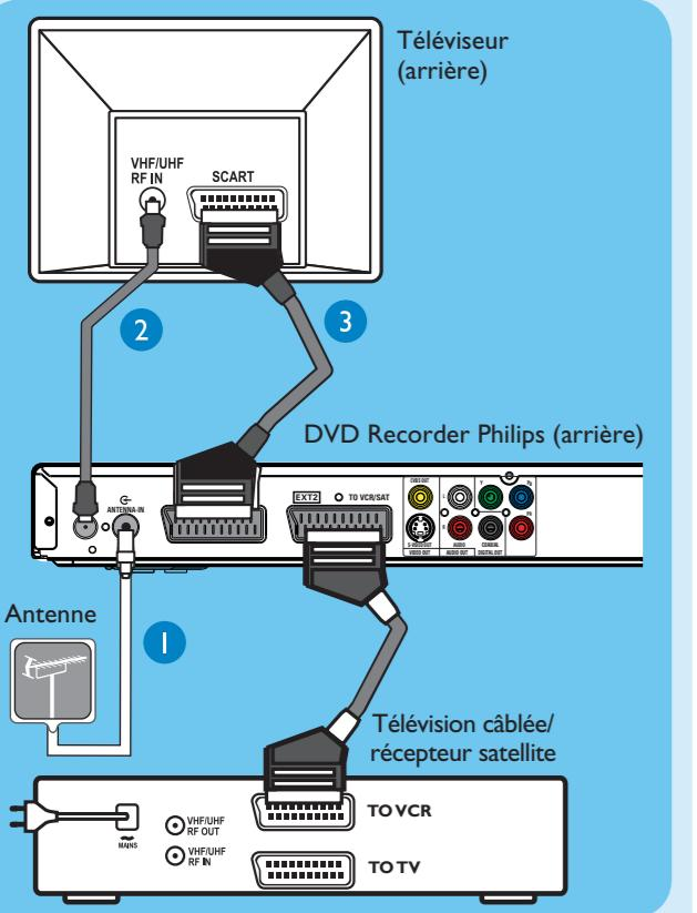
1 Débranchez le câble d'antenne existant du téléviseur et branchez-le sur l'entrée **ANTENNA IN** du DVD Recorder.
