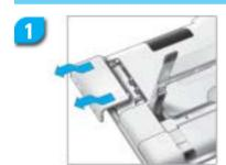
Abra la cubierta del adaptador LAN sin cables apretando las pestañas y deslizando la cubierta en la dirección indicada.
