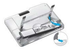
Abra la cubierta de la batería apretando las
