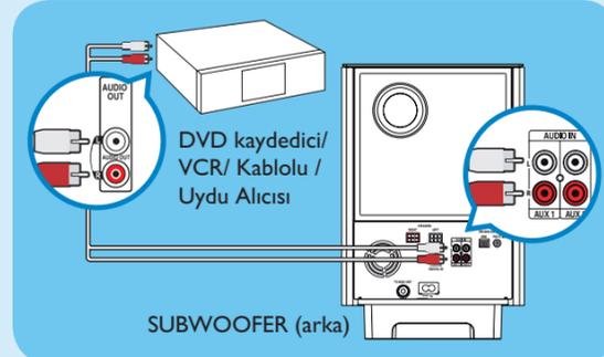
**Not:** Dinlemek istedięiniz kaynaęa göre 'AUX1' veya 'AUX2' seçeneklerinden birini seçmek için uzaktan kumanda üzerinde bulunan **AUX/DI** düğmesine basın.
