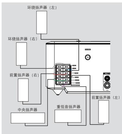
请将扬声器导线连接至 **SPEAKERS** 扬声器端子。注意颜色和丝印的匹配。颜色线（有标记）连接至“+”极，黑色线（无标记）连接至“-”极。如图所示，必须把扬声器导线的裸露部分充分插入扬声器端子内并夹紧。
