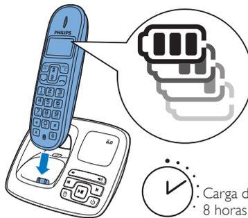
Coloque el microteléfono en la estación base para cargarlo. Cuando el microteléfono esté colocado correctamente en la estación base, oír un pitido.
