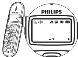
▬▬ Muestra la conexión entre el microteléfono y la base. Cuantas más barras aparezcan, mejor será la conexión.
