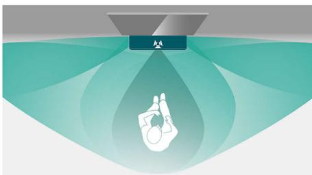
La base de la technologie WaveFlector est un système à 3 haut-parleurs, deux latéraux et un central, entre deux réflecteurs. Les deux haut-parleurs latéraux s'intègrent entre deux réflecteurs ayant fait l'objet de recherches,
