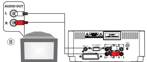
Ⓑ Um den Sound Ihres Fernsehgeräts über diesen DVD-Player wiederzugeben, verbinden Sie mithilfe eines Cinch-Kabels (nicht mitgeliefert) die Buchse **AUX IN** auf der Rückseite des DVD-Players mit den entsprechenden **AUDIO OUT**-Buchsen am Fernsehgerät.
