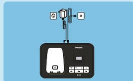
2. Hubungkan kabel saluran dan kabel listrik ke konektornya masing-masing di belakang stasiun base.
