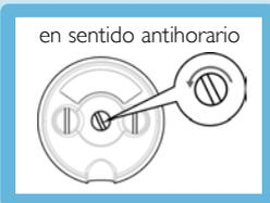
2. Coloque las baterías tal como se indica y vuelva a colocar la cubierta.
