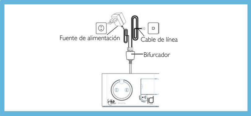
2. Conecte el bifurcador suministrado al conector de la parte posterior de la estación base y luego enchufe el cable de línea y el cable de alimentación en las clavijas de línea correspondientes que se encuentran en el bifurcador.
