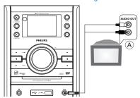
® Um den Ton Ihres Fernsehgeräts über diesen DVD-Player wiederzugeben, verbinden Sie mithilfe eines Cinch-Kabels (nicht mitgeliefert) die Buchse **LINE-IN** auf der Vorderseite des DVD-Players mit den entsprechenden AUDIO OUT-Buchsen am Fernsehgerät.
