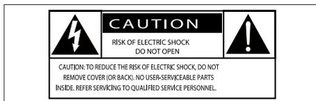
Ce symbole éclair signifie que les composants non isolés de l'appareil peuvent provoquer une décharge électrique. Pour la sécurité de votre entourage, ne retirez pas le couvercle. Le point d'exclamation signale des points importants et vous invite à consulter la documentation fournie afin d'éviter tout problème de fonctionnement et de maintenance.
