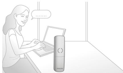
Način rada "handsfree" koristi glasan ugrađeni zvučnik za pojačavanje pozivateljevog glasa, što omogućava govor i slušanje tijekom poziva bez držanja telefona uz uho. To je naročito korisno kada poziv želite podijeliti s drugima ili jednostavno raditi nešto drugo tijekom poziva.
