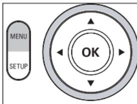
Для выполнения оптимальной настройки воспроизведения используйте меню **SETUP**, позволяющее выполнить точную подстройку. Выделите нужный пункт с помощью кнопок **▲,▼,◀,▶** и нажмите **OK**.
