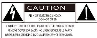
Ova „munja“ označava da neizolovani materijal unutar uređaja može da prouzrokuje strujni udar. Nemojte da uklanjate poklopce radi bezbednosti svih osoba u vašem domaćinstvu.
