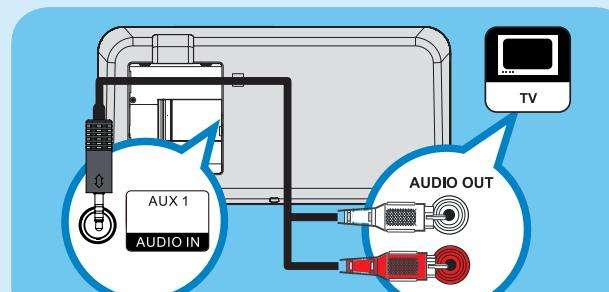
**Примечание** Для воспроизведения аудиосигнала от этого соединения последовательно нажмите **AUX/DI /MP3 LINK**, до отображения на индикаторной панели AUX1 INPUT.
