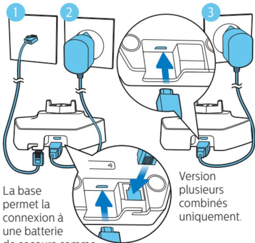
La base permet la connexion à une batterie de secours comme autre source d'alimentation secteur pendant une coupure de courant.
