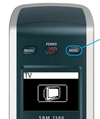
Premere **MODE** sull'SRM7500 per ottenere la funzione di telecomando universale. Sullo schermo viene visualizzata l'icona dell'ultimo dispositivo selezionato.
