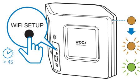
**5** Περιμένετε μέχρι η ένδειξη λειτουργίας/κατάστασης του AW3000 να ανάψει σταθερά με λευκό χρώμα και μετά πατήστε **Next** (Επόμενο) στην οθόνη της εφαρμογής.
