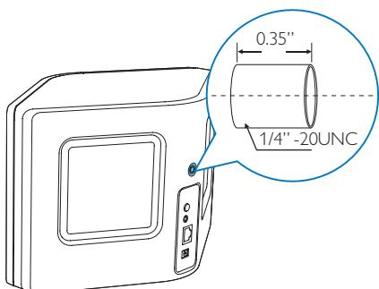
Από αυτήν την οπή, μπορείτε να αναρτήσετε εύκολα τη συσκευή στον τοίχο χρησιμοποιώντας ένα κατάλληλο επιτοίχιο στήριγμα. Θα πρέπει να αγοράσετε ένα επιτοίχιο στήριγμα, καθώς δεν περιλαμβάνεται. Ακολουθήστε τις οδηγίες που συνοδεύουν το επιτοίχιο στήριγμα που αγοράσατε.
