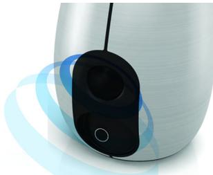
Il carico acustico bass-reflex utilizza un bass pipe sintonizzato sul volume acustico della cassa altoparlante per riprodurre bassi profondi da strutture compatte. Il bass-pipe appositamente progettato aiuta il flusso d'aria e genera bassi profondi e potenti, anche ad alto volume, e riduce al minimo la turbolenza dell'aria che potrebbe causare deformazione.
