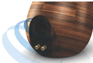
Der Akustiklautsprecher mit Bassreflex-Design nutzt eine auf das akustische Volumen der Lautsprecherbox abgestimmte Bassröhre zur Wiedergabe von tiefen Bässen über das kompakte Gehäuse. Das durchdachte Profil der Bassröhre unterstützt den Luftstrom, ermöglicht einen tiefen, satten Bass selbst bei hohen Lautstärken und minimiert gleichzeitig Luftverwirbelungen, die zu einer Verzerrung führen können.
