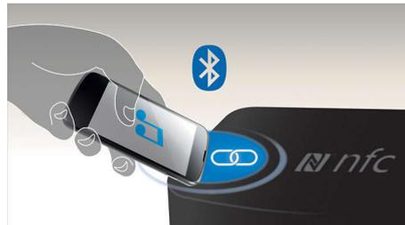
Emparelhe dispositivos Bluetooth facilmente com a tecnologia NFC (Near Field Communication - comunicação por aproximação) de um só toque. Basta tocar com o smartphone ou o tablet com NFC na área NFC de um altifalante para o ligar, iniciar o emparelhamento Bluetooth e iniciar a transmissão de música.
