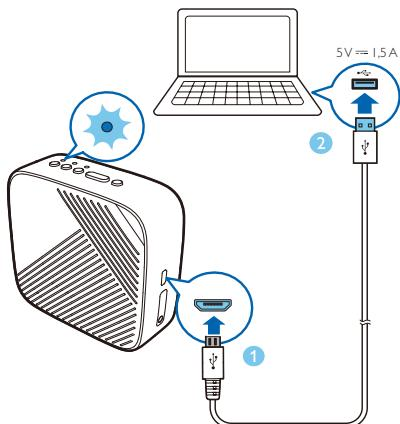
Povežite USB kabl između USB priključka na zvučniku i USB priključka na računaru ili punjaču.
