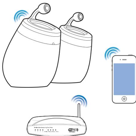
Чтобы подключить устройство DS9800W к существующей домашней сети Wi-Fi, необходимо применить настройки домашней сети Wi-Fi к DS9800W. Это можно сделать двумя способами (в зависимости от типа используемого маршрутизатора Wi-Fi).
