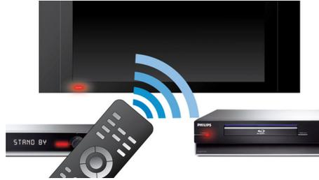
EasyLink consente di controllare più dispositivi con un unico telecomando. Utilizza il protocollo standard del settore HDMI CEC per condividere funzionalità tra vari dispositivi attraverso il cavo HDMI. Con un solo comando, puoi far funzionare contemporaneamente tutte le apparecchiature compatibili con HDMI CEC. Funzioni come lo standby e la riproduzione possono essere controllate in tutta semplicità.
