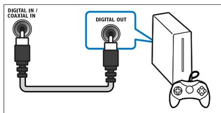
**1** Usando um cabo coaxial, insira o conector **COAXIAL** do Home Theater no conector
