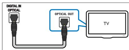
**1** Usando um cabo óptico, insira o conector **OPTICAL** do Home Theater no conector **OPTICAL OUT** da TV ou do outro dispositivo.
