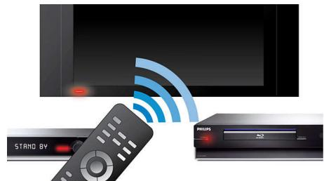
EasyLink ви позволява да управлявате няколко устройства, например DVD плейъри, Blu-ray плейъри, тонколона SoundBar, система за домашно кино и телевизори и др. с едно дистанционно управление. Използва стандартния протокол HDMI CEC за споделяне на функции между устройствата чрез HDMI кабела. С едно натискане на бутон можете да управлявате едновременно всички свързани устройства с възможности за HDMI CEC. Функциите като готовност и възпроизвеждане сега може да се изпълняват с удивителна лекота.
