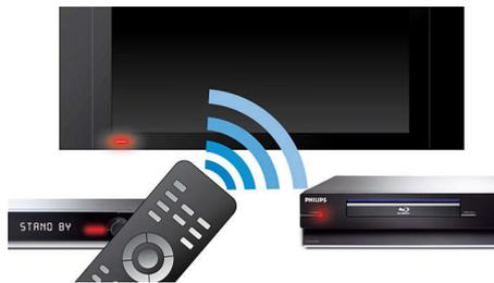
EasyLink vous permet de contrôler plusieurs appareils (lecteurs de DVD/Blu-ray, barres de son, home cinémas, téléviseurs, etc.) avec une seule télécommande. Le protocole standard HDMI CEC est utilisé pour mettre en commun les fonctionnalités de plusieurs appareils via un câble HDMI. D'une simple pression sur un bouton, vous pouvez contrôler simultanément tous les appareils connectés compatibles HDMI CEC. Désormais, l'exécution de
