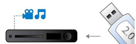
L'USB (Universal Serial Bus) est un protocole permettant de relier facilement des ordinateurs, des périphériques et des équipements électroniques grand public. Les appareils USB ultrarapides ont un taux de transfert de données allant jusqu'à 480 Mbit/s (il était de 12 Mbit/s sur les premiers appareils USB). Avec le port USB 2.0 ultrarapide, vous n'avez qu'à brancher votre appareil USB, sélectionner un film, un titre ou une photo et lancer la lecture.
