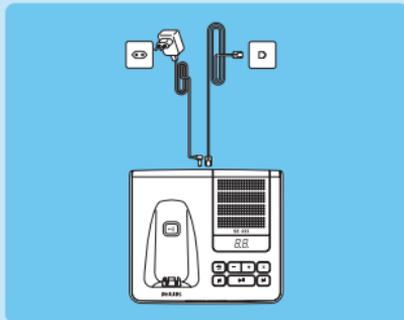
2. Schließen Sie Telefonkabel und Netzkabel an ihre jeweiligen Anschlüsse hinten an der Basisstation an.
