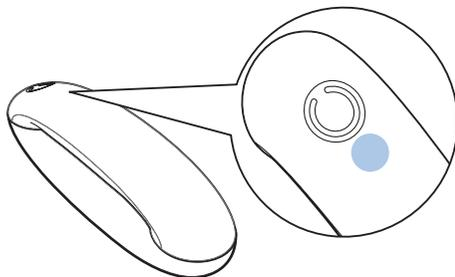
Cargue su microteléfono conectándolo en cualquier dirección. Cuando el microteléfono esté colocado correctamente en la estación base, oirá un tono de conexión (consulte 'Ajuste del tono de conexión' en la página 18). El LED en la parte posterior del microteléfono parpadea.
