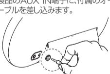
3 オーディオケーブルのもう一方を、接続する外部機器の出力端子に差し込みます。
