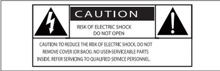
위의 '번개' 표시는 장치 내의 미절연 소재로 인해 감전의 위험이 있음을 나타냅니다. 가족의 안전을 위해 덮개를 열지 마십시오.
