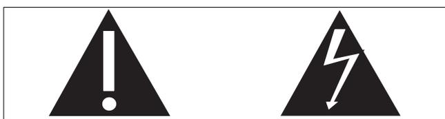
“Молния” обозначает неизолированный материал в устройстве, который может привести к поражению электрическим током. В целях безопасности не снимайте крышку устройства.
