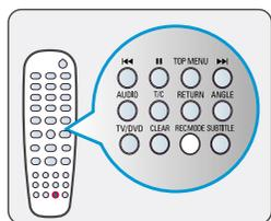
**4c** Pulse **REC MODE** para seleccionar el modo de grabación deseado. Permite definir la calidad de la imagen y el tiempo de grabación máximo de un disco.
