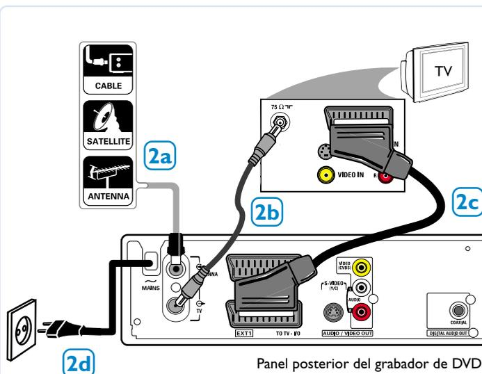
**2a** Conecte la señal de satélite/cable de la antena existente (o del receptor por satélite/cable [RF OUT o TO TV]) a la toma de entrada **ANTENNA** de la parte posterior del grabador de DVD.
