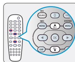
**5d** Pulse **REC SOURCE** para seleccionar {Tuner} (Sintonizador) y, a continuación, utilice las teclas ▲▼ para seleccionar el número de programa.
