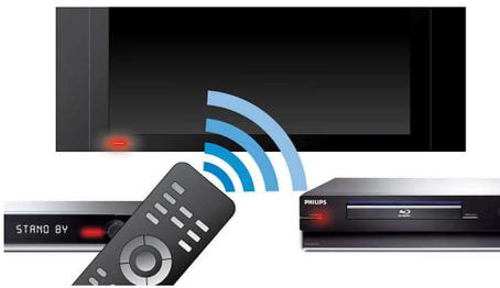
EasyLink te permite controlar varios dispositivos con un solo control remoto y utiliza el protocolo estándar HDMI CEC para que los dispositivos conectados compartan las mismas funciones a través de un cable HDMI. Con sólo presionar un botón, puedes controlar todos los equipos HDMI CEC de forma simultánea y las funciones de modo de espera y de reproducción son muy fáciles de usar.
