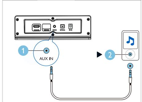
Verbinden Sie den **AUX IN**-Anschluss an der Soundbar über ein 3,5-mm-Stereo-Audiokabel mit dem **AUX**-Anschluss an einem Fernseher oder einem anderen Gerät.
